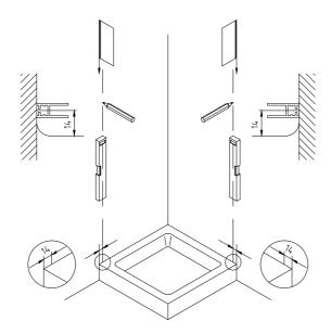
Löcher markieren, bohren und Rahmenwinkel befestigen.
