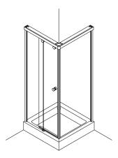
Vor der Montage Glasflächen mit handelsüblichem Glasreiniger im Bereich der Klemmflächen reinigen.
